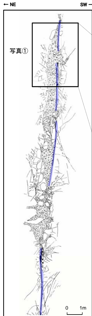
原子炉建屋底盤(EL-7.1m)に認められる S-1の詳細スケッチ
