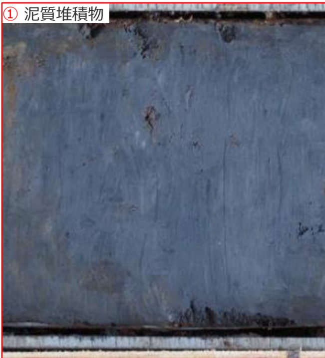
① 泥質堆積物 泥層中に砂粒子はほとんど見られない。
