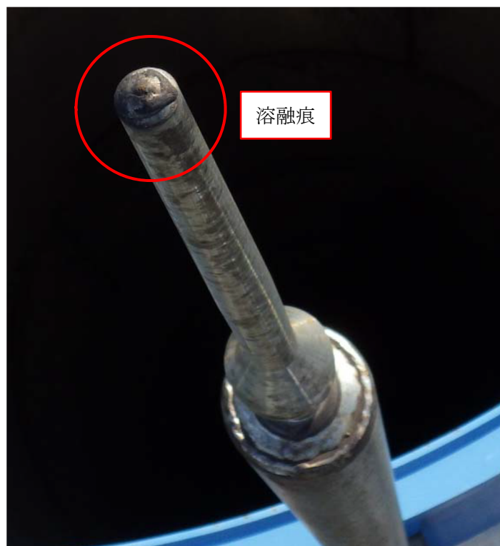
別添2-第1図 落雷による溶融痕
