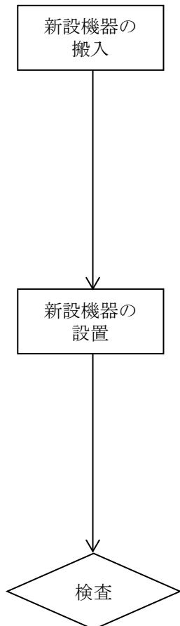
補足図－3 通信連絡設備（所内通信連絡設備）の工事フロー
