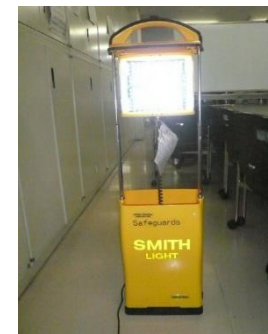
仮設照明(蓄電池式)
