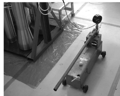
加圧ポンプ：ハンドルを上下に動かすことでタンクの水をカプセル側に供給し加圧する。
