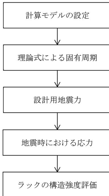
図 2-1 ラックの耐震評価フロー
