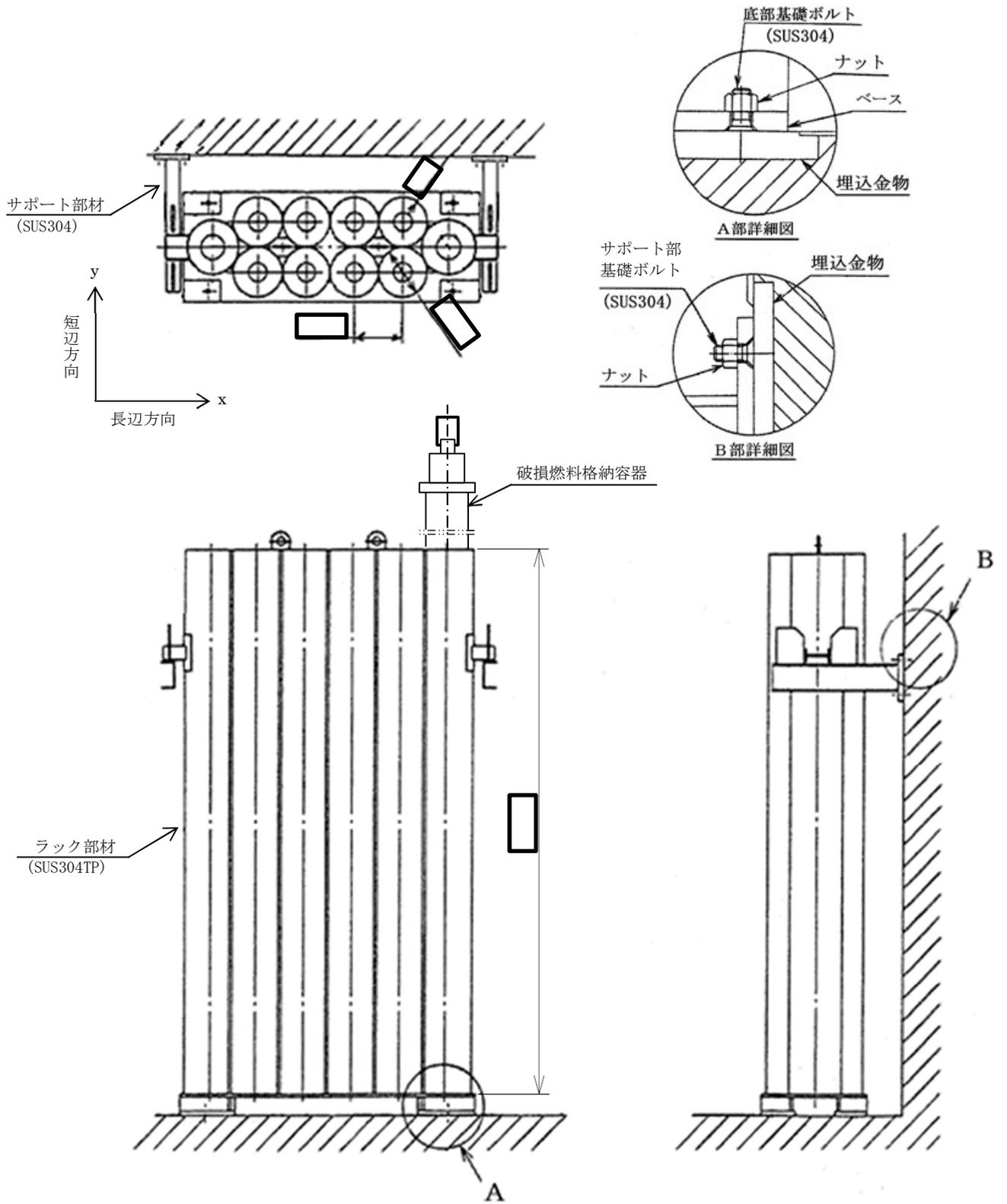
図 3-1 構造概要図 (単位 : mm)
