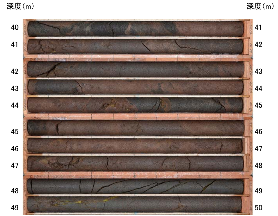
ボーリング①C-9.0-1 コア写真[40~50m]
