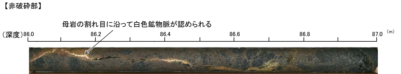
母岩中の割れ目に沿って白色鉱物(フィリップサイト)の鉱物脈が認められる事例 (試料II. J-10.8SW-1孔 深度86.18m付近)
