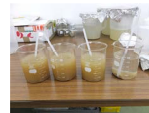
ビーカーを用いた水簸の例
