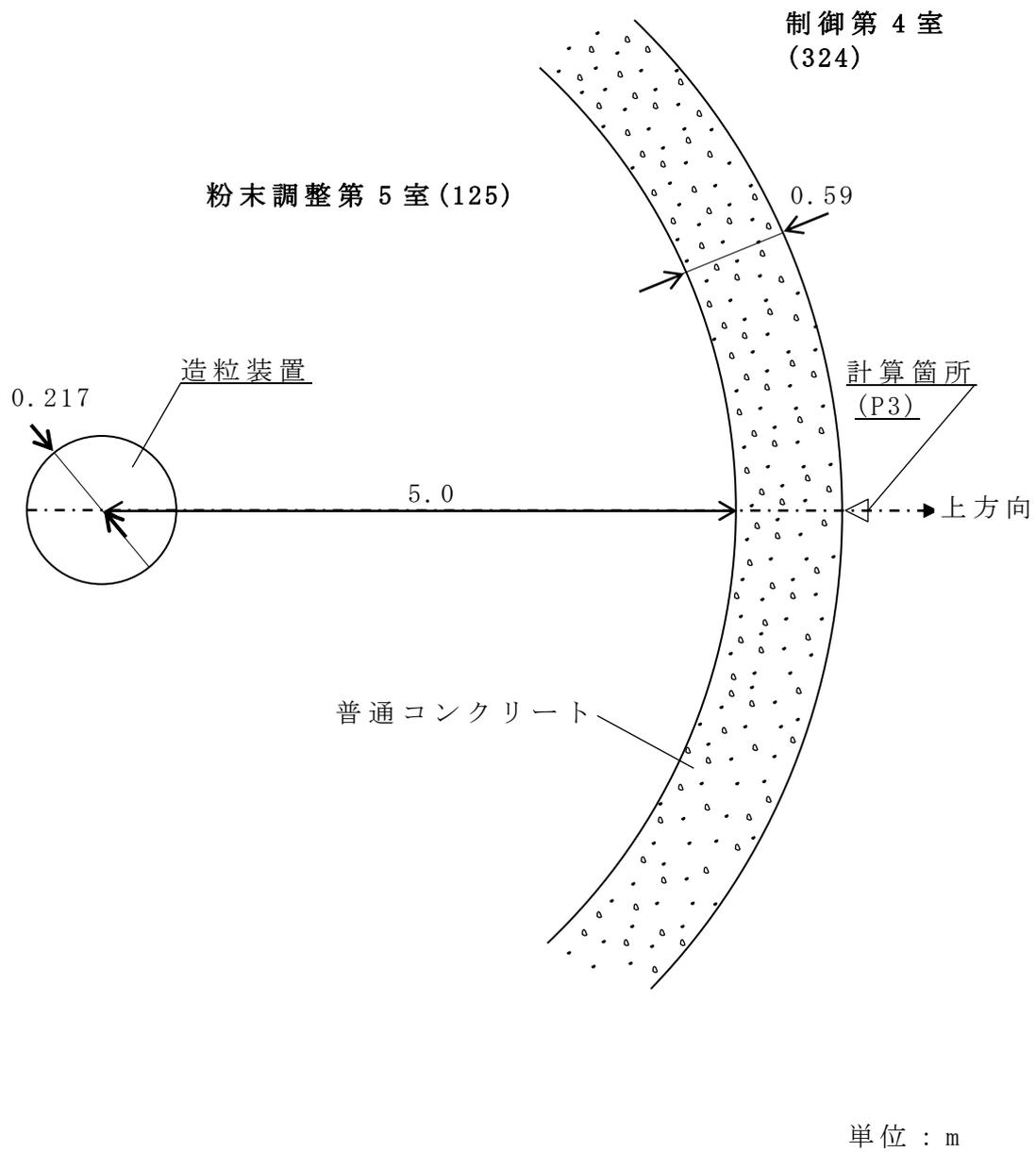
第2.2-1図(6) 造粒装置：上方方向線量率計算モデル図
