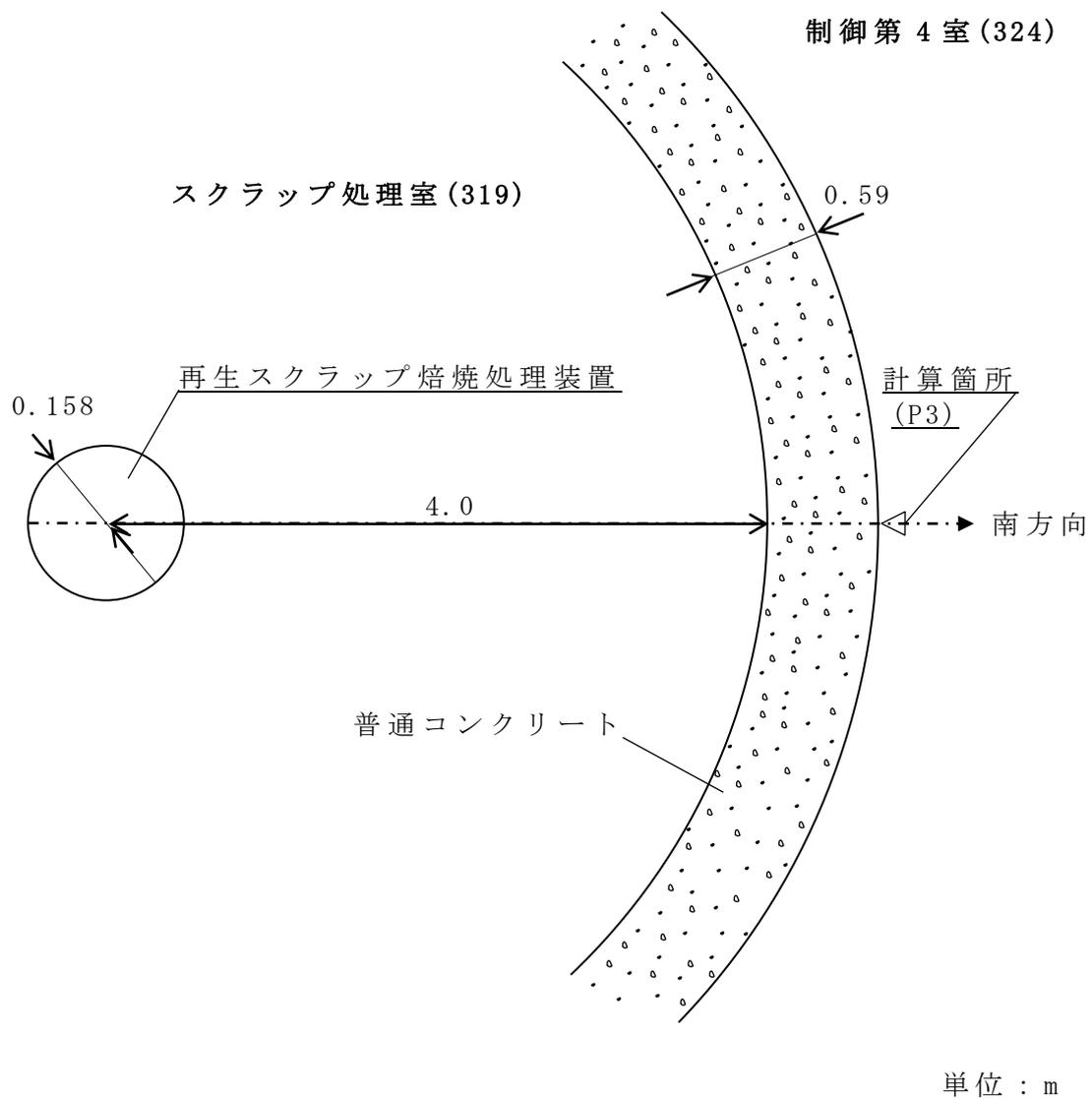
第2.2-1図(3) 再生スクラップ焙焼処理装置：南方向線量率計算モデル図
