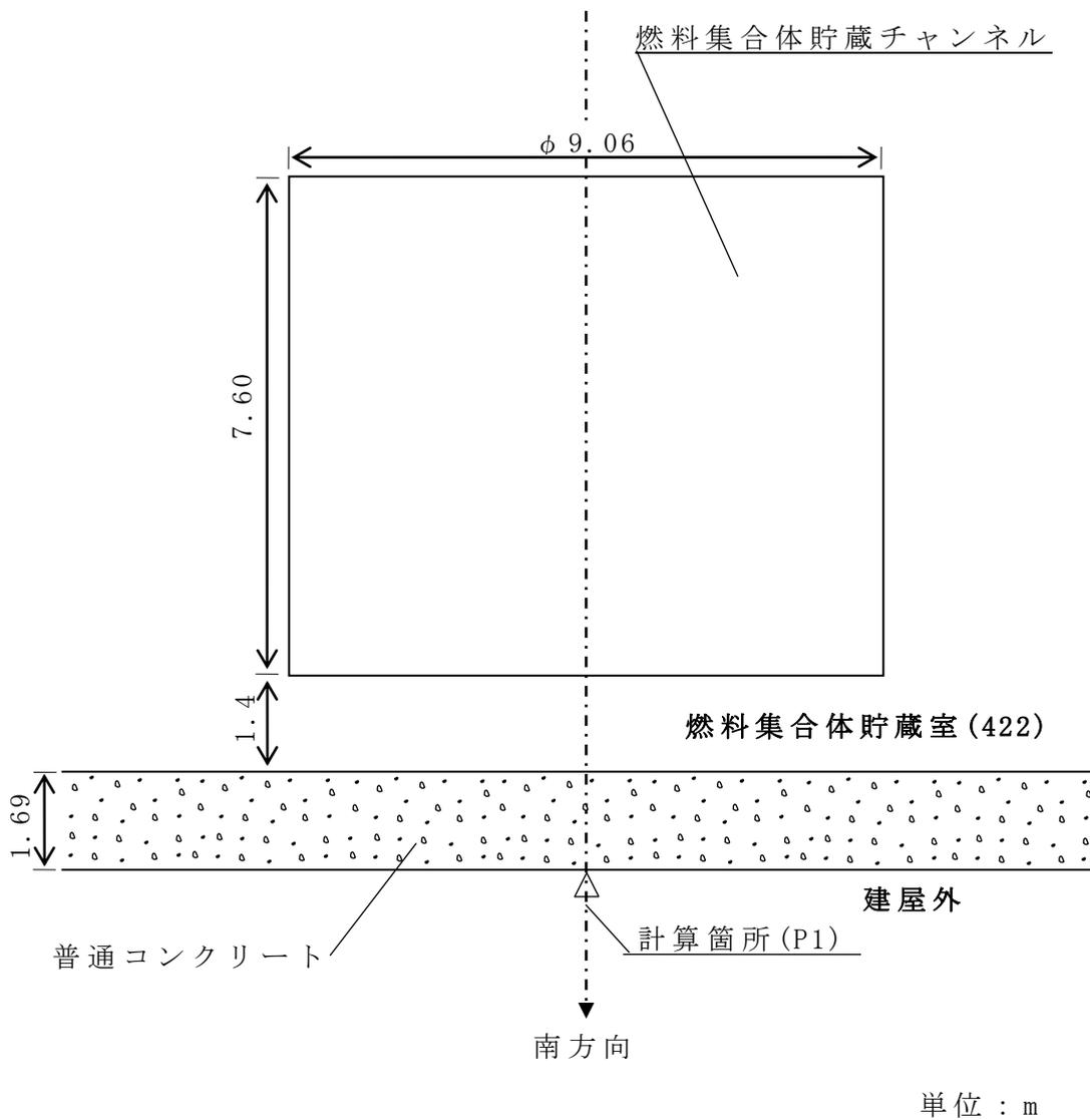
第 2.2-1 図(1) 燃料集合体貯蔵チャンネル：南方方向線量率計算モデル図
