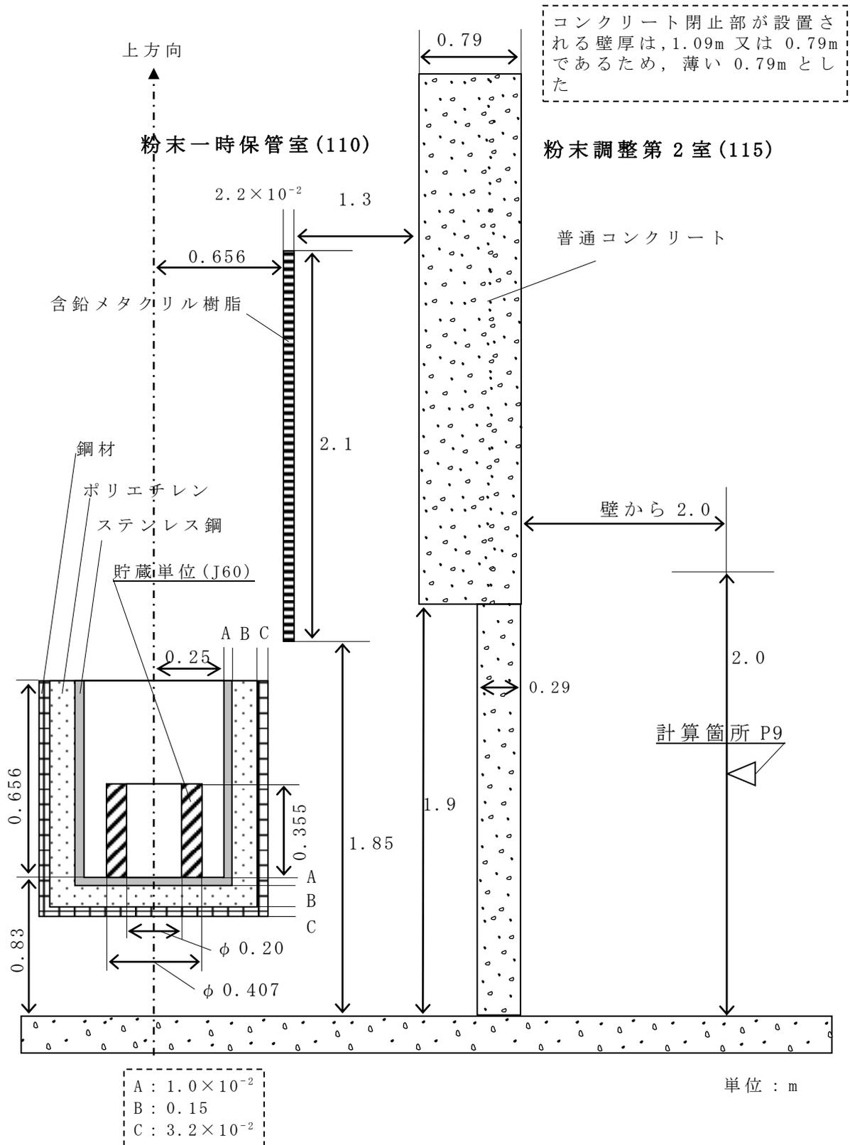
第 2.2-1 図 (14) 粉末一時保管装置：西方向線量率計算モデル図
