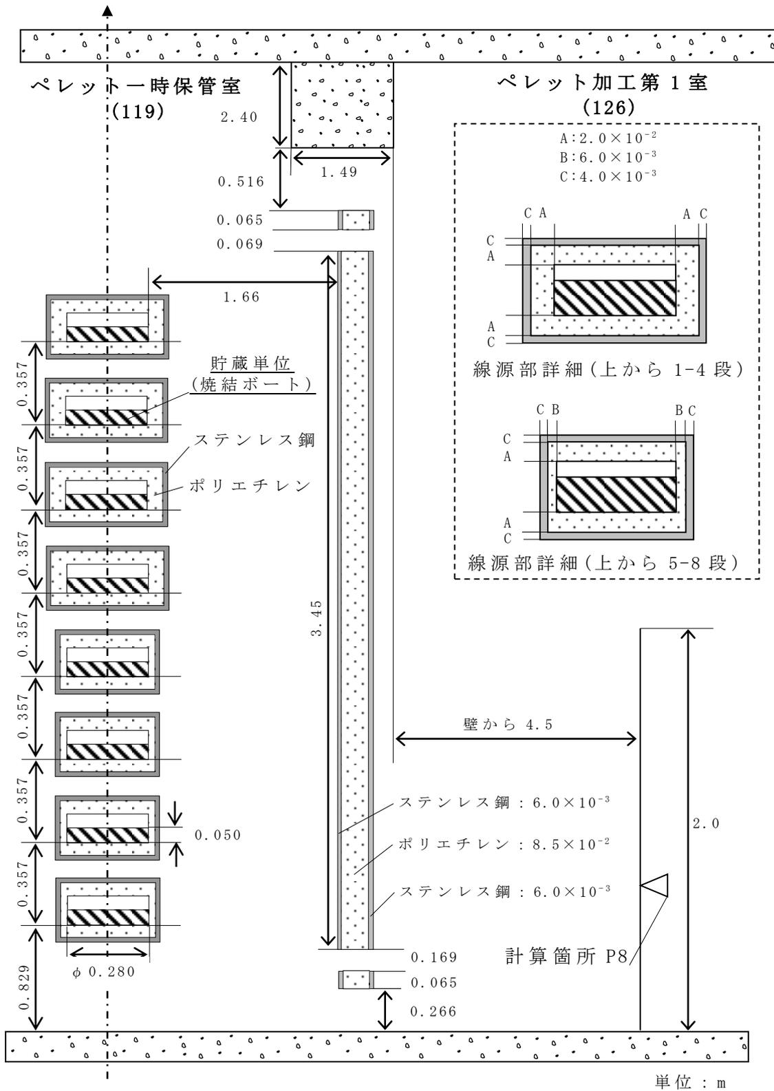
第 2.2-1 図 (13-1) ペレット一時保管棚 : 南方向線量率計算モデル図 (線源形状 : 有限円筒, 1 棚目 1 行目モデル)
