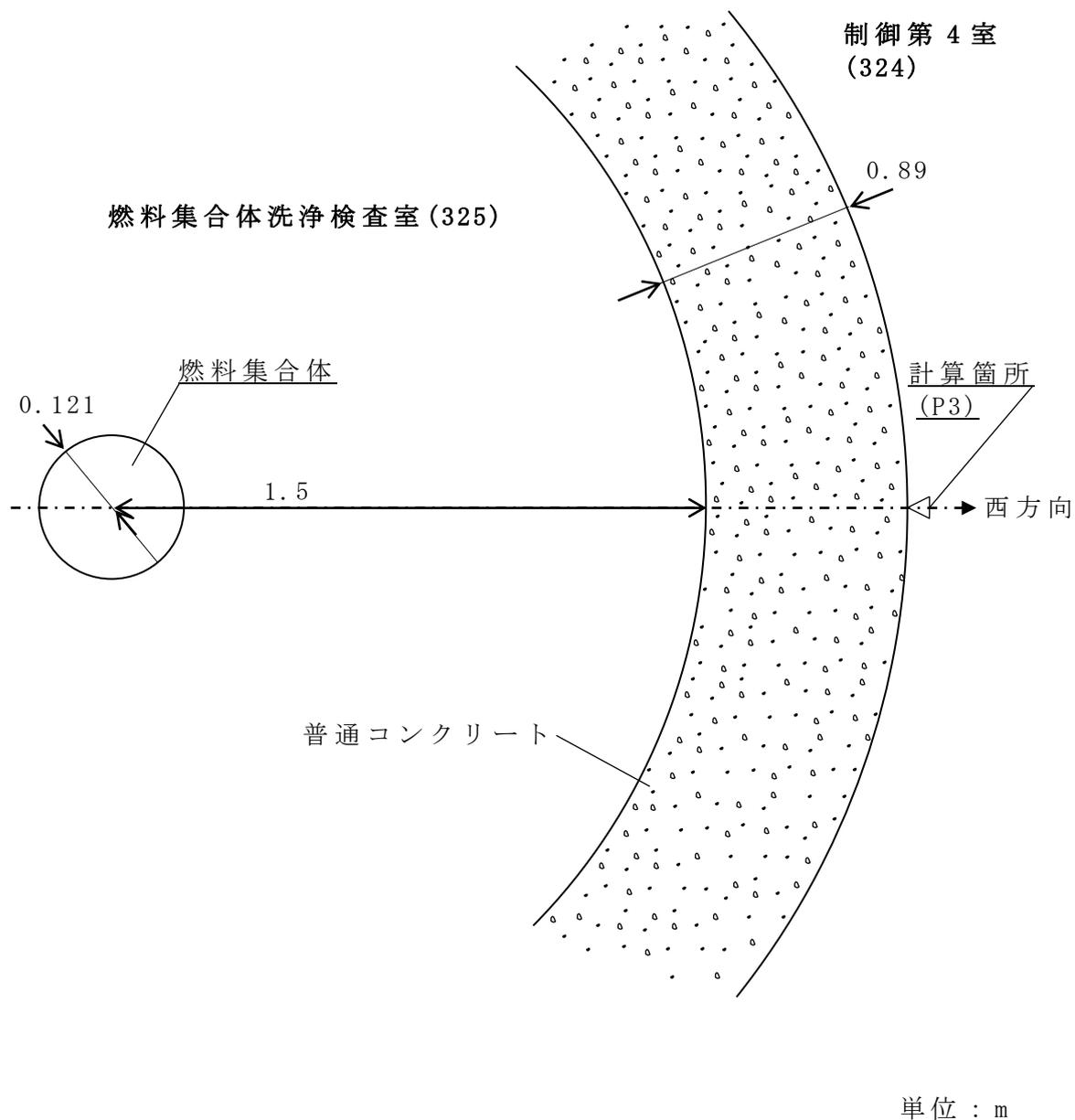
第2.2-1図(4) 燃料集合体：西方向線量率計算モデル図
