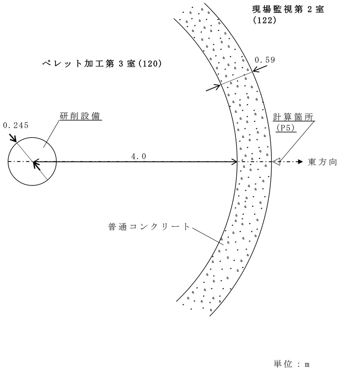
第2.2-1図(8) 研削設備：東方向線量率計算モデル図
