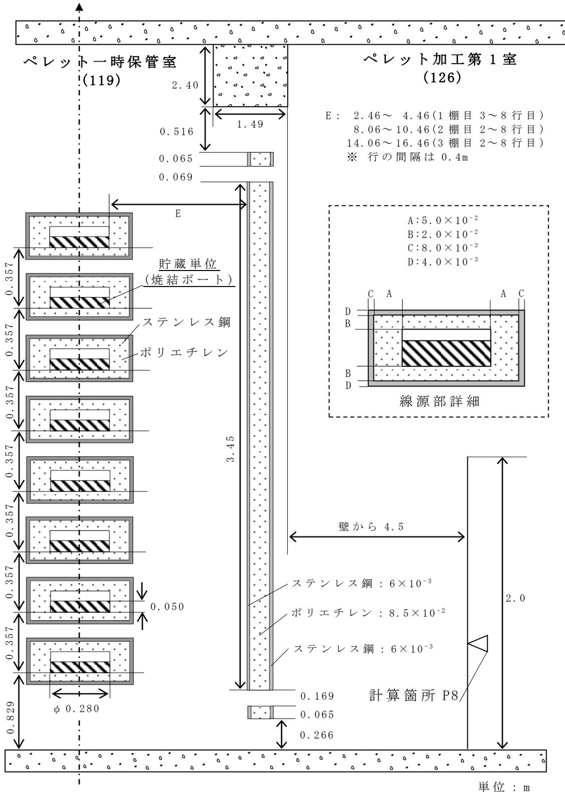
第 2.2-1 図 (13-4) ペレット一時保管棚：南方向線量率計算モデル図
