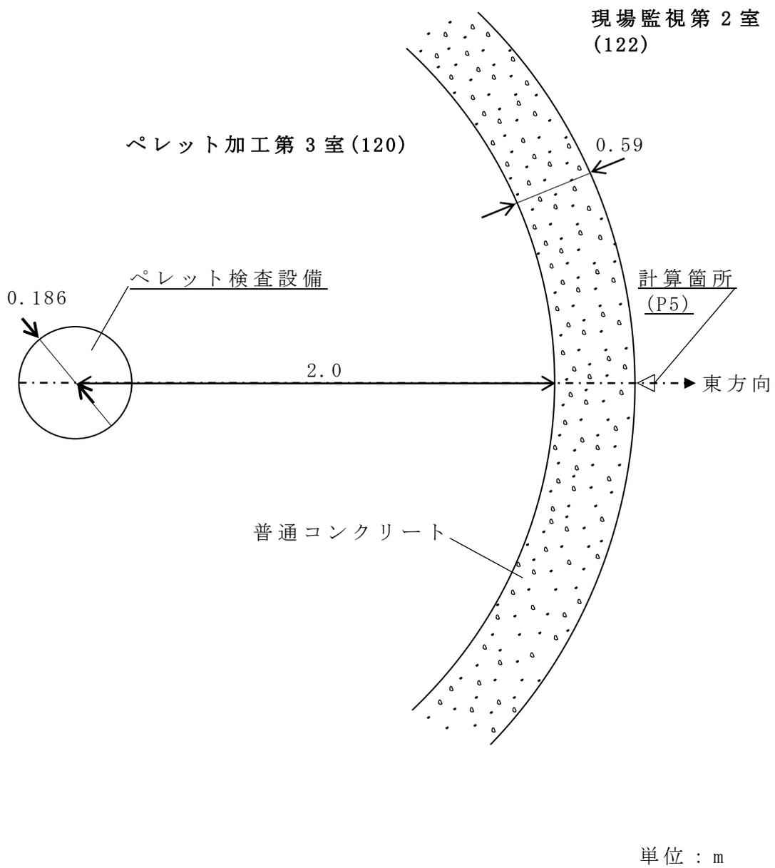
第2.2-1図(9) ペレット検査設備：東方向線量率計算モデル図
