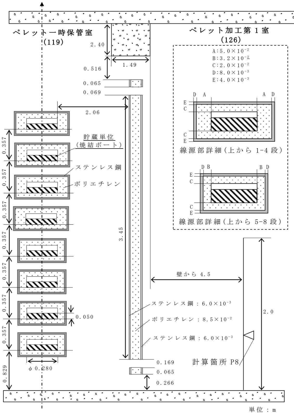
第 2.2-1 図 (13-2) ペレット一時保管棚：南方向線量率計算モデル図
