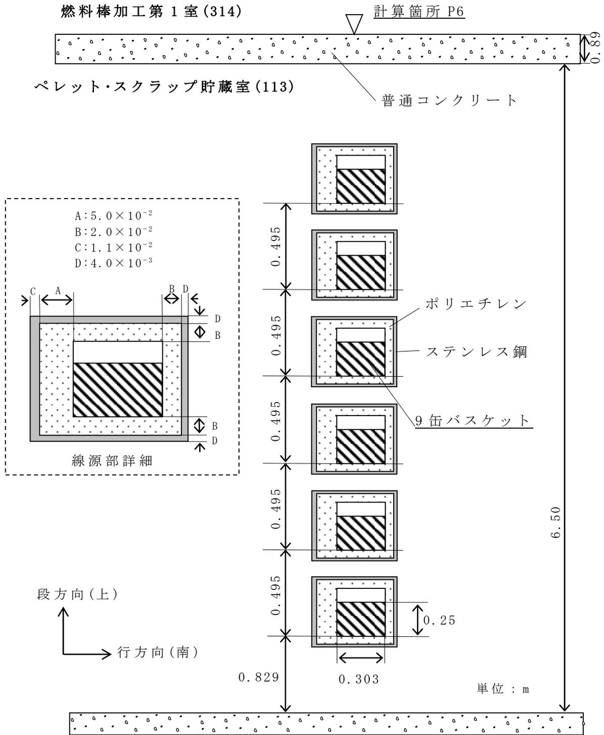
第2.2-1図(10) スクラップ貯蔵棚：上方向線量率計算モデル図
