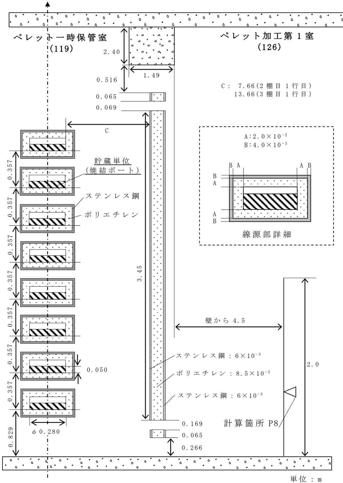
第 2.2-1 図 (13-3) ペレット一時保管棚：南方向線量率計算モデル図
