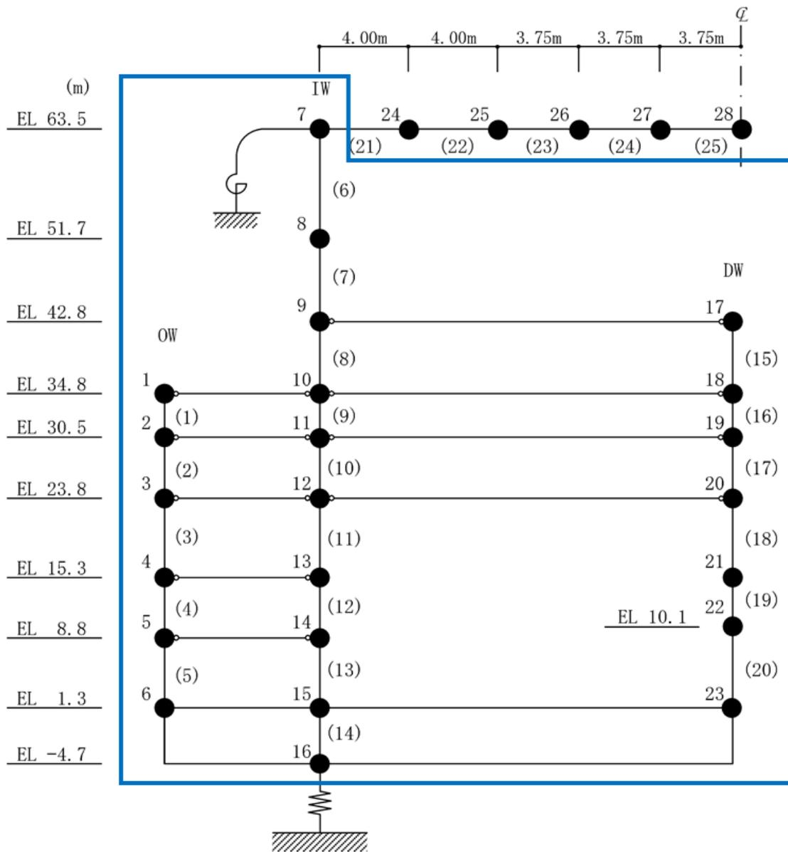
別図 1-3 原子炉建物地震応答解析モデルの等価繰返し回数の算出点 (鉛直方向)
