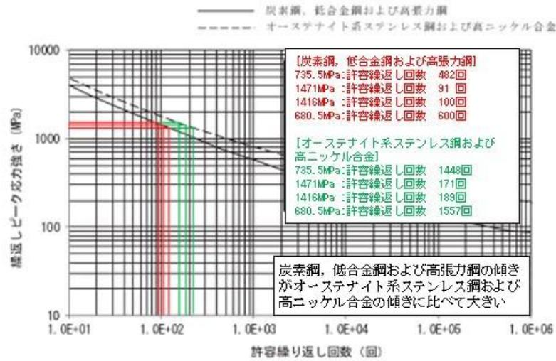
炭素鋼, 低合金鋼および高張力鋼の等価繰返し回数:
