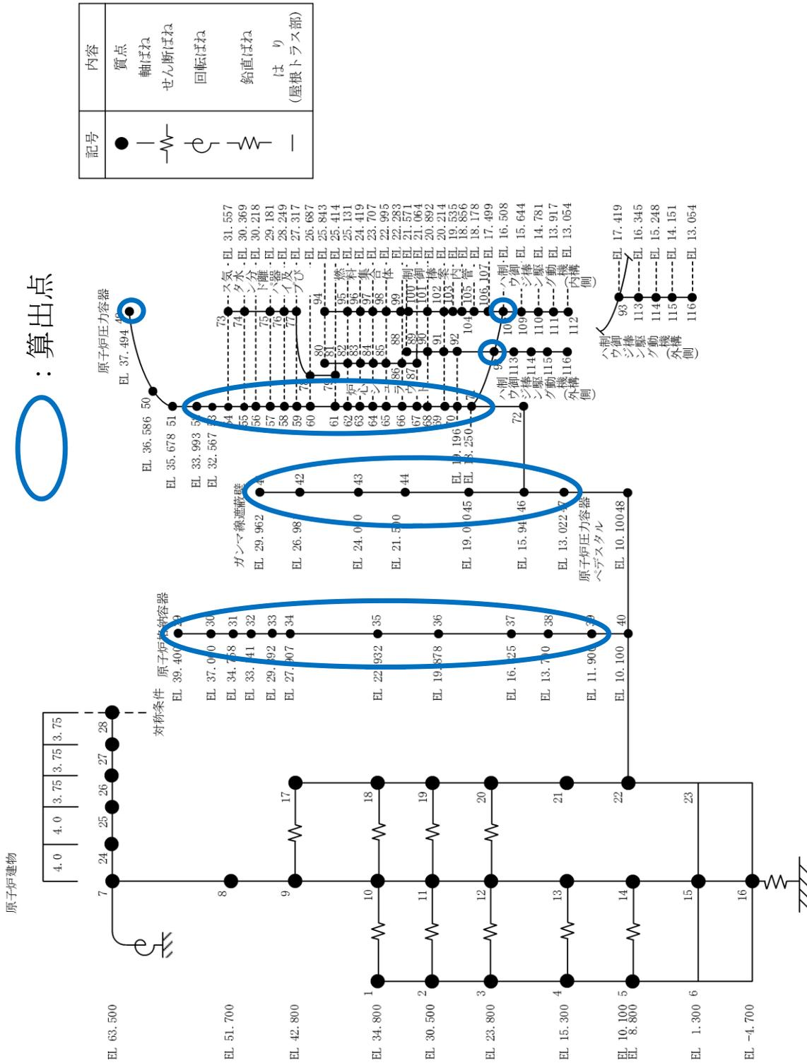
別図 1-6 原子炉本体地震応答解析モデルの等価繰返し回数の算出点 (鉛直方向)
