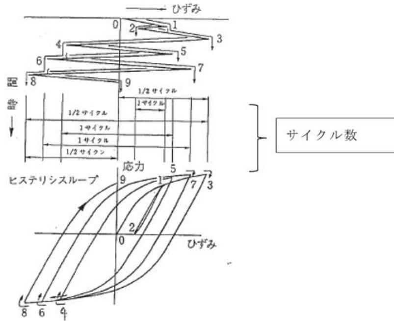
別図8-1 レインフロー法の概要
