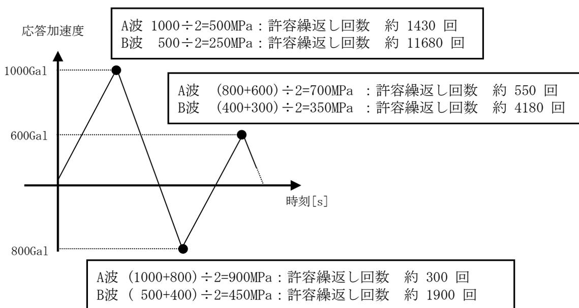
別図9-1 1質点系の時刻歴応答波形
