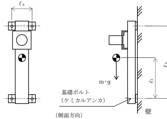
【原子炉圧力 (PX298-8B) の耐震性についての計算結果】
