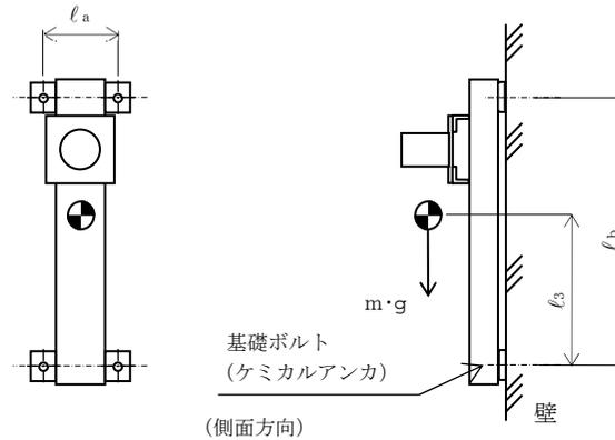
【原子炉圧力 (PX298-8C) の耐震性についての計算結果】
