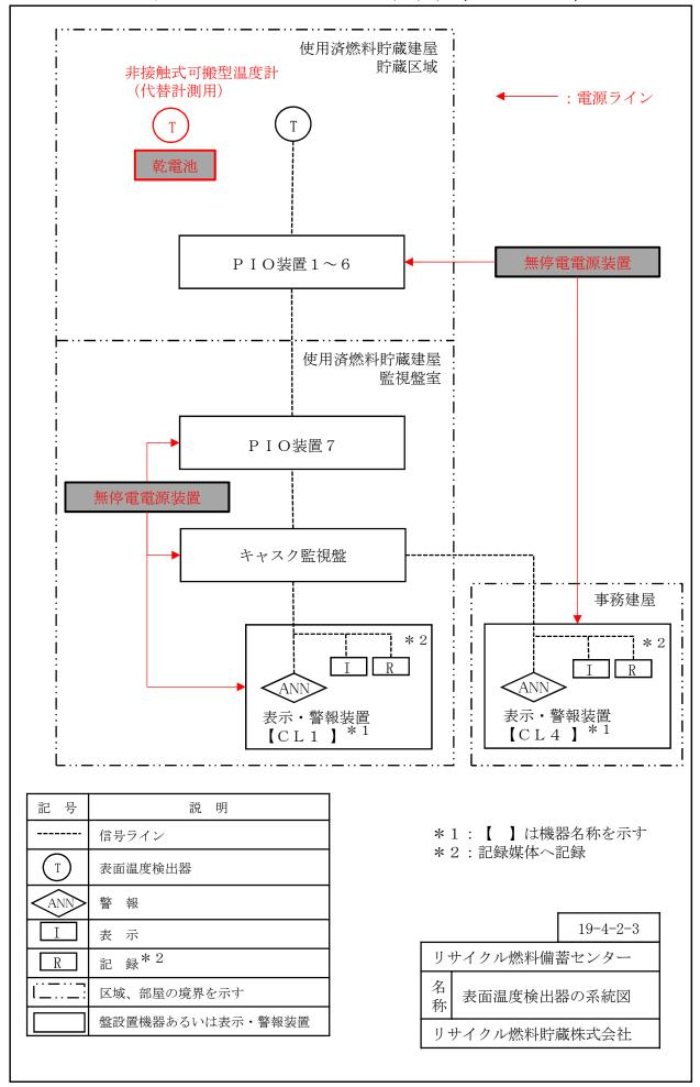
添付3 給排気温度検出器の系統図(電源追記)
