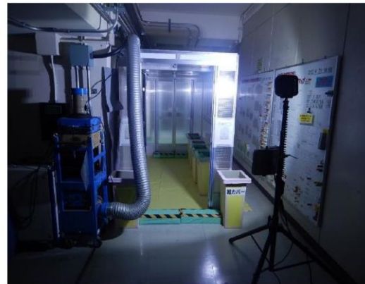
図 4 中央制御室のチェンジングエリアにおける重大事故等発生時の照明の照度確認状況
