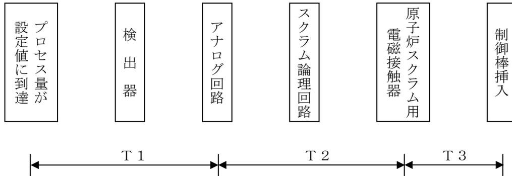
T 1 : プロセス量が設定値に達してから検出器が検知し, アナログ回路の信号がスクラム論理回路に発信されるまでの検出遅れ時間
