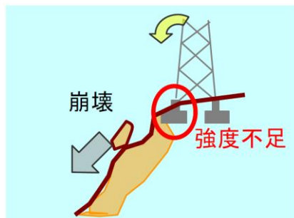
【急傾斜地の崩壊】
