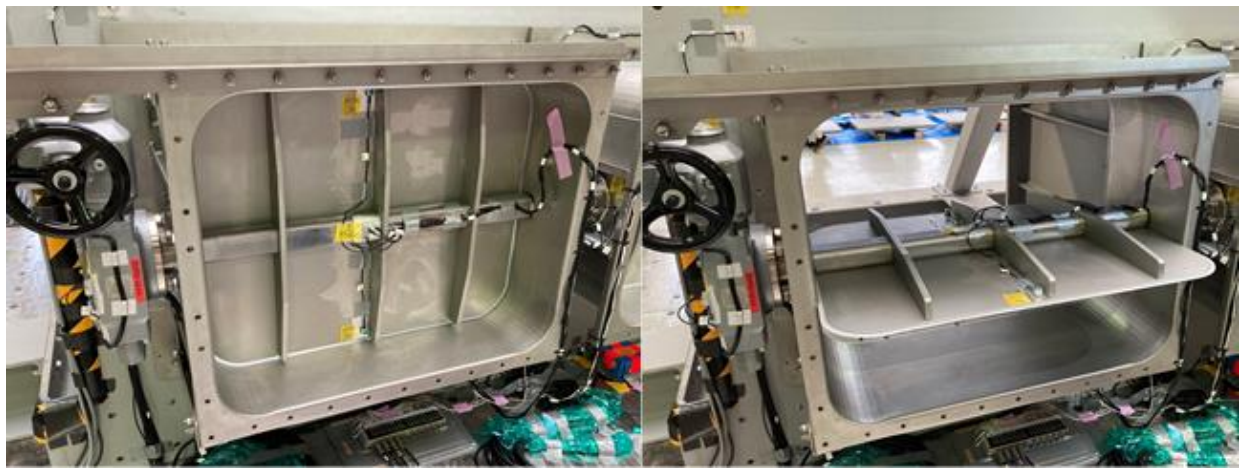
図3-2 BOP閉止装置の駆動概要図（左：閉止，右：開放）
