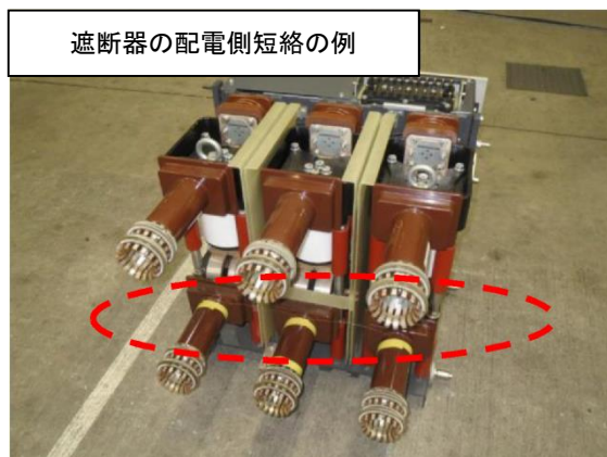
図4-5-1 遮断器の短絡箇所 (M/C試験時)
