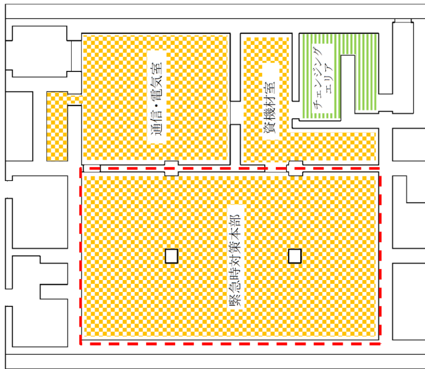
図 3-1-1 緊急時対策所換気空調系の設備構成図並びに緊急時対策所正圧化エリア図 (2/2)
