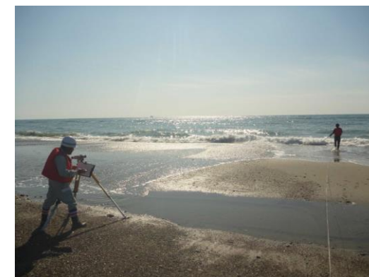
海岸線地形測量実施状況 (汀線部)
