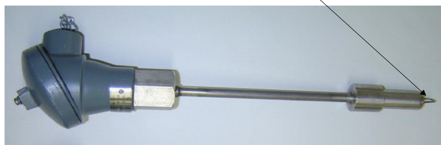
第 1.1 図 通電式（プラグ型）のナトリウム漏えい検出器の構造概要
