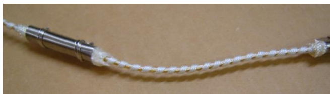
第 1.2 図 通電式（リボン型）のナトリウム漏えい検出器の構造概要
