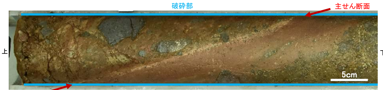
コア写真(No.9切羽底盤)
