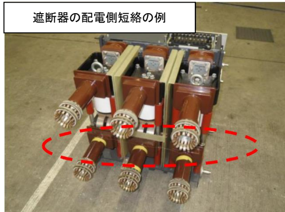
図4-5-1 遮断器の短絡箇所 (M/C 試験時)
