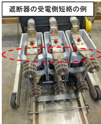
図4-5-1 遮断器の短絡箇所 (M/C 試験時)
