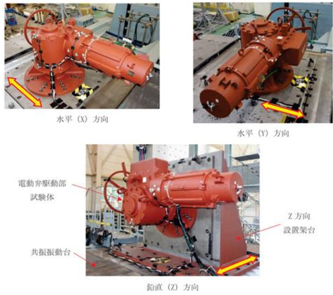
図 2. 4-3 電動弁駆動部試験体据付状況
