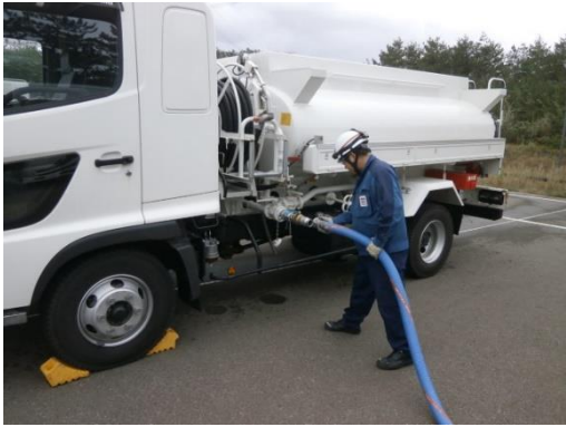
タンクローリへのホース接続
