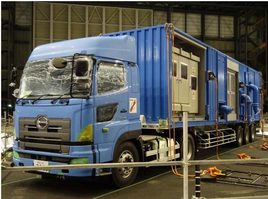
図 3-5 試験構成 (移動式代替熱交換設備) (6/10)
