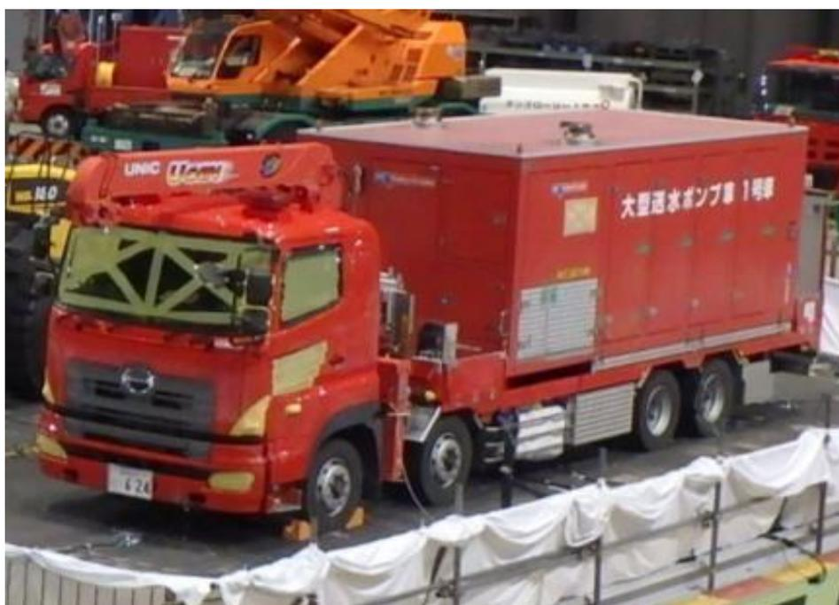
図 3-5 試験構成(大型送水ポンプ車 (原子炉補機代替冷却系及び原子炉建物放水設備用))
