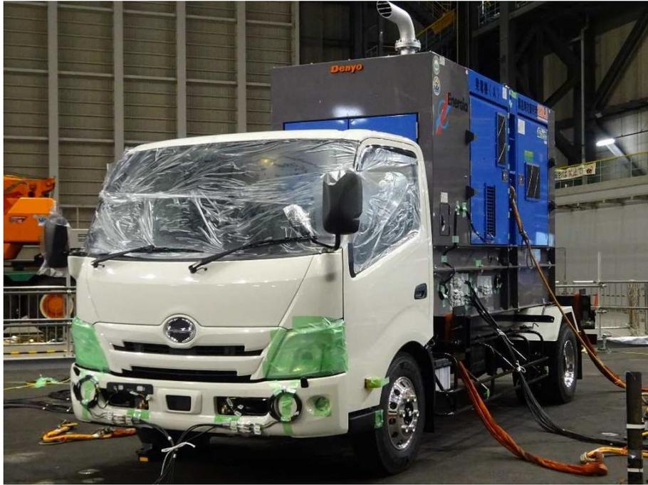
図 3-5 試験構成（緊急時対策所用発電機）（9/10）
