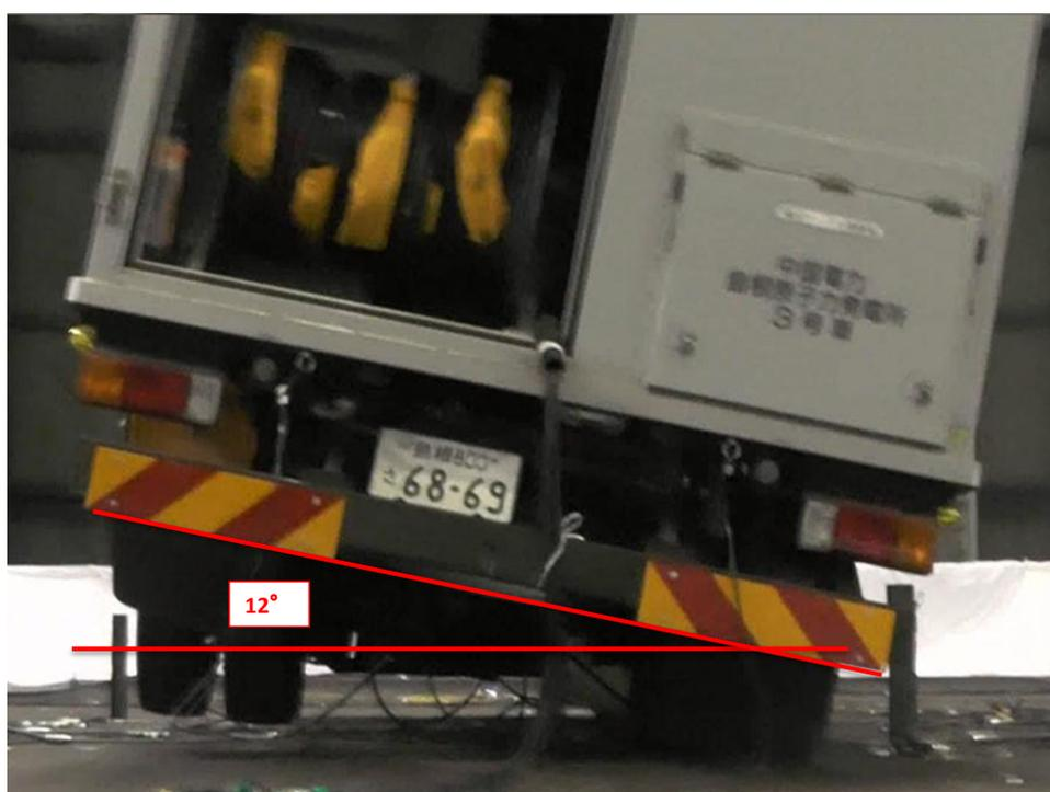
図 6-1 高圧発電機車（タイプ I）の最大傾き角の計測結果
