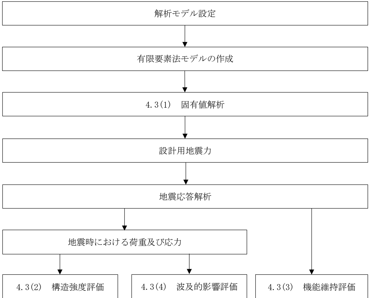
図 4-23 可搬型空気浄化設備の評価フロー
