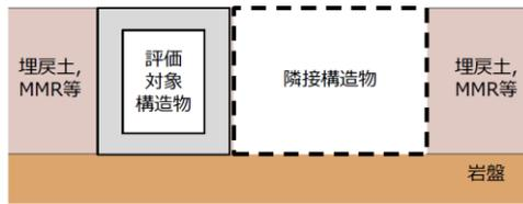
(a) 評価対象構造物と隣接構造物が接している場合
