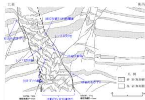
H断層系の一般的特徴 (H-3断層露頭の事例)
