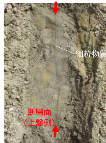
上盤側の断層面を研磨した状況
