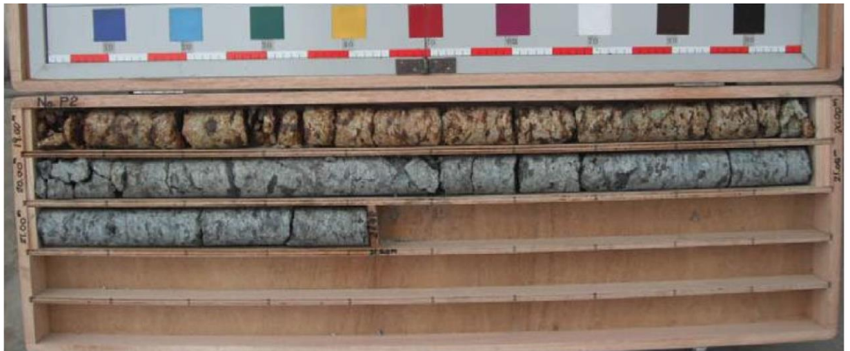
図 1-7 ボーリングコア写真 (P2 : E-2 地点の参考)
