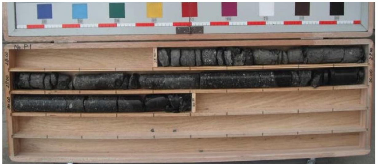
図 1-4 ボーリングコア写真 (P1 : E-1 地点の参考)
