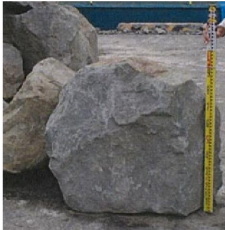
被覆石の寸法（1，2号機北側護岸）
