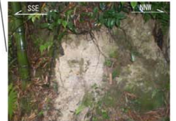
高階層 砂礫主体で砂を伴う。砂層の層理面はほぼ水平 (E-W/3° S)
