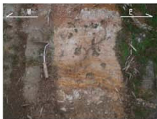
高階層 砂質シルト。層理面はほぼ水平 (N82° E/2° S)
