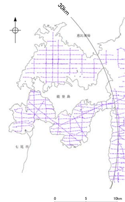
上図凡例 海上保安庁水路部: スパーク・シングルチャンネル 七尾湾調査海域の音波探査航跡図※
