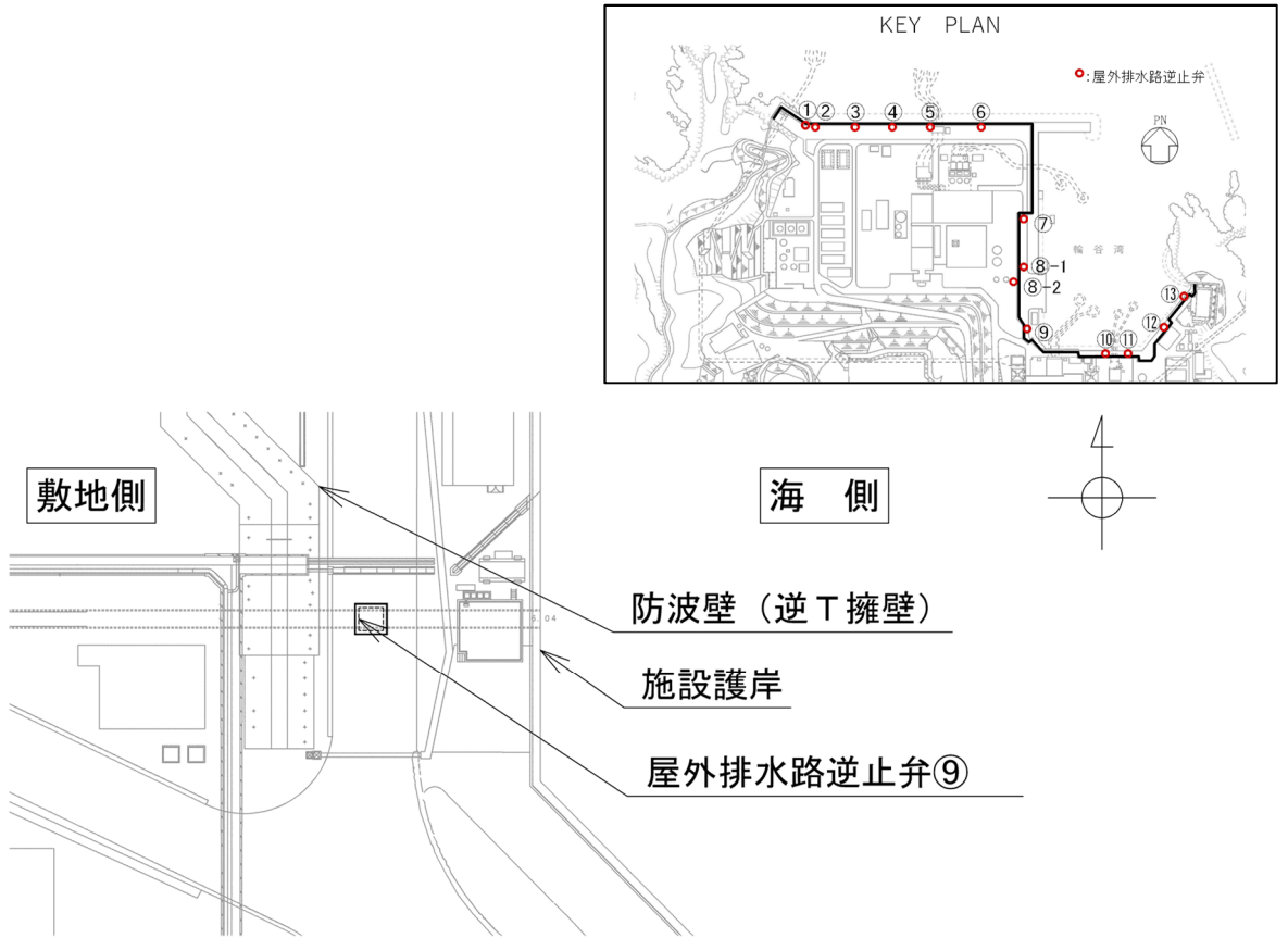
图 3-10 (1) 屋外排水路逆止弁⑨平面图
