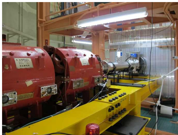
図 B-5 中性子発生設備（電磁石からターゲット方向を見たところ）
