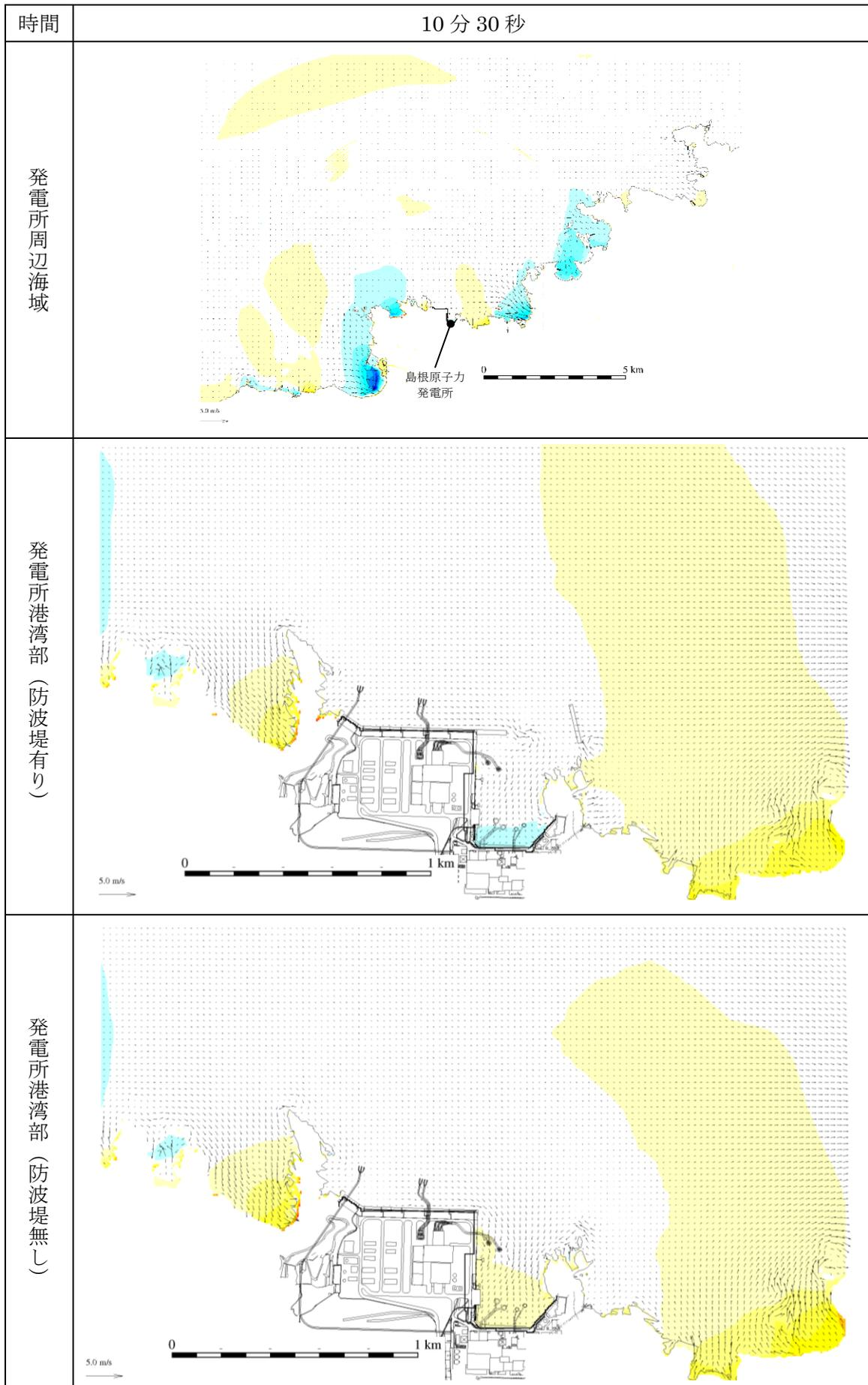
図 4-22 基準津波 4 の水位変動・流向ベクトル
