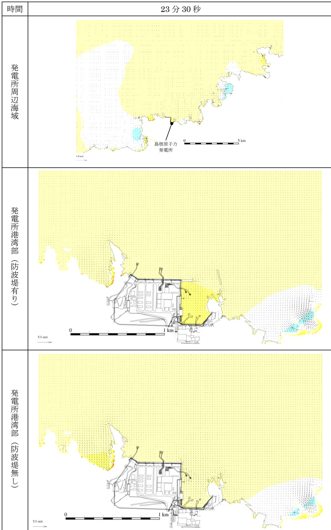
図 4-48 基準津波 4 の水位変動・流向ベクトル
