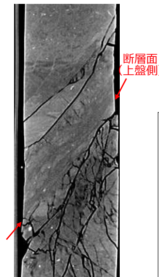
CT画像※ (左の写真付近の断面)
