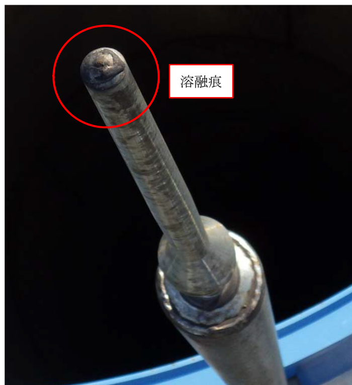
別添2-第1図 落雷による溶融痕
