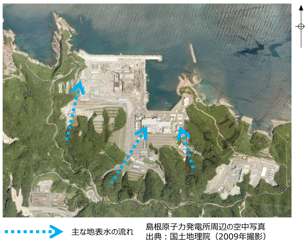
図 3.3-2 発電所周辺の主な地表水の流れ
