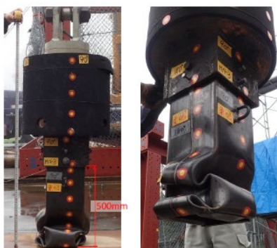
補足別図8 試験後の柔パイプ重錘の変形状況（参考文献(2)より）
