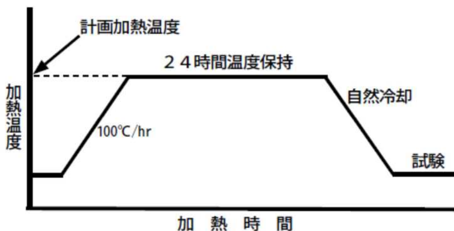
別添 1 - 1 図 コンクリート供試体加熱パターン
