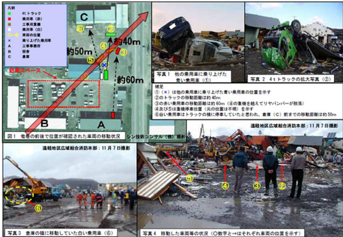
佐呂間竜巻(2006. 11. 7)による被災状況: 工事事務所敷地内の車両被災 (竜巻経路 → を追加)
