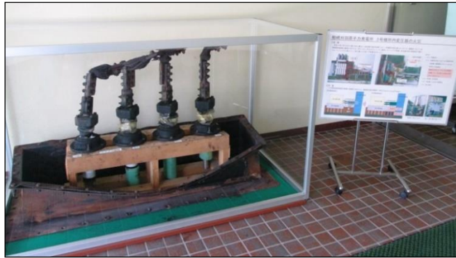
柏崎刈羽 3号炉 所内変圧器の火災
