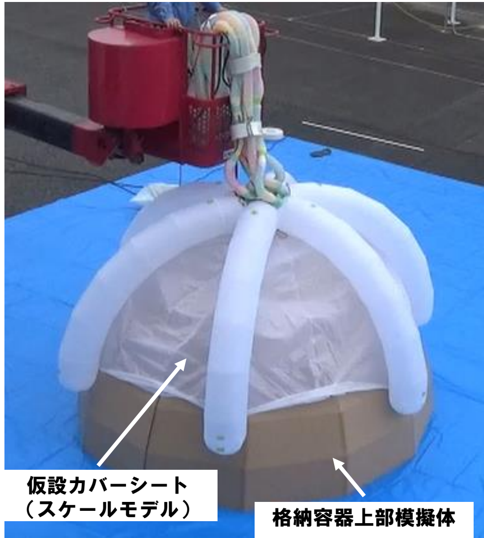
仮設カバーシートの敷設イメージ (スケールモデルを使用)
