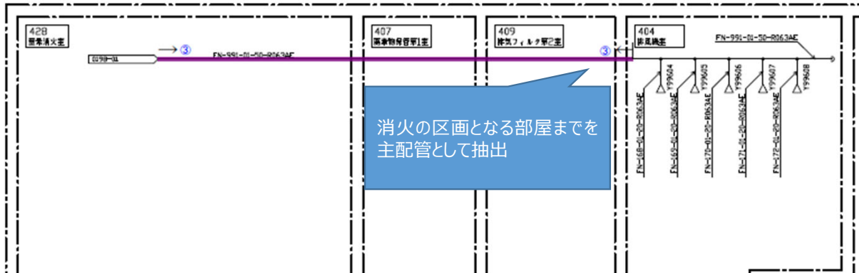
例1) 火災防護設備（窒素消火装置）
