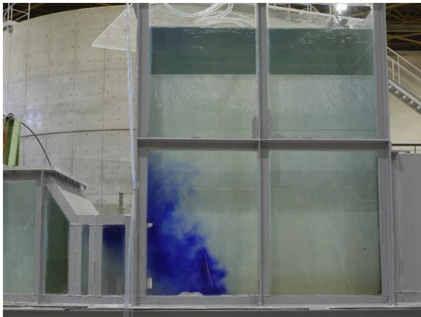
取水槽（通水時）
