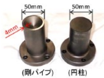
補足別図3 飛翔体の衝突部形状（参考文献(1)より）
