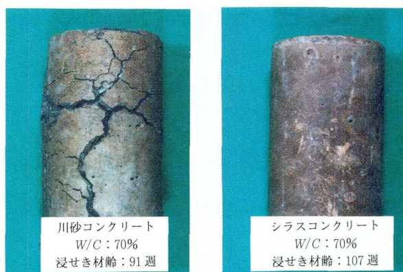
写真-2 10% \text{Na}_2\text{SO}_4 水溶液に浸せきさせたコンクリートの外観
