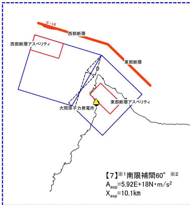
断層傾斜角 60^\circ の震源モデル
