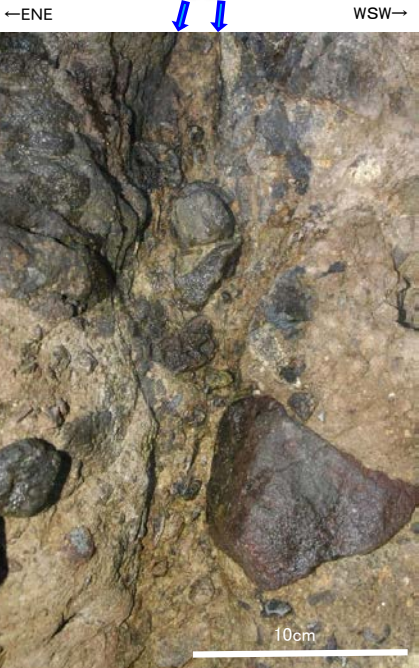
写真①拡大 谷地形(2)と走向が調和的な連続性のよい節理(左:加筆なし, 右:加筆あり)
