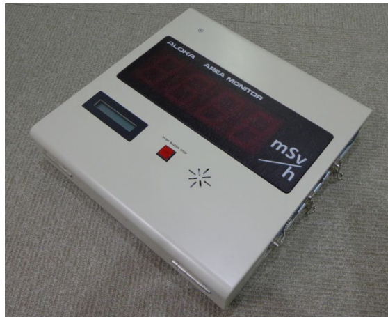
第5図 緊急時対策所エリアモニタ
